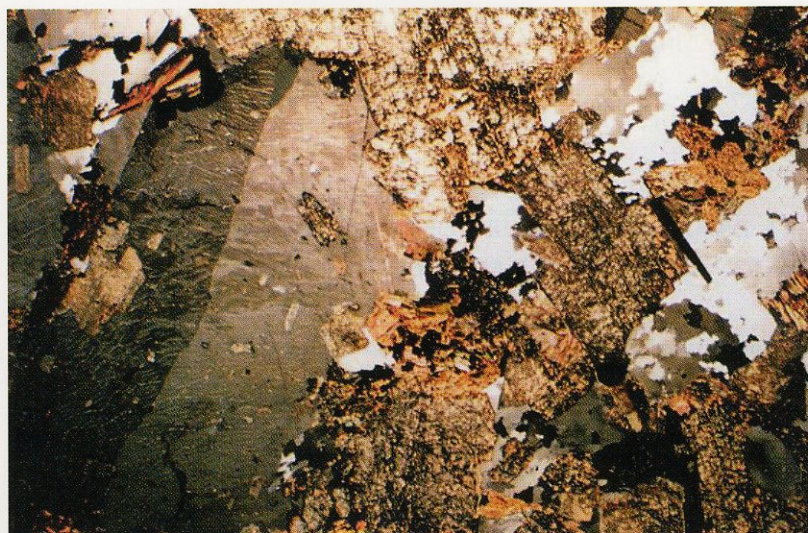
10b. Microphotographie d'une lame mince de roche granitique altérée en lumière polarisée analysée (hauteur de la microphotographie : 12 mm).
