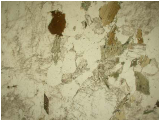
1a. Photographie d'un macroéchantillon et microphotographies d'une lame mince en lumière polarisée non analysée et en lumière polarisée analysée du granite de Flamanville (hauteur des microphotographies : 13 mm)
