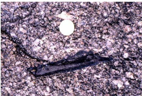
1b. Photographies de deux enclaves présentes dans le granite de Flamanville (la pièce de 1 euro donne l'échelle)
